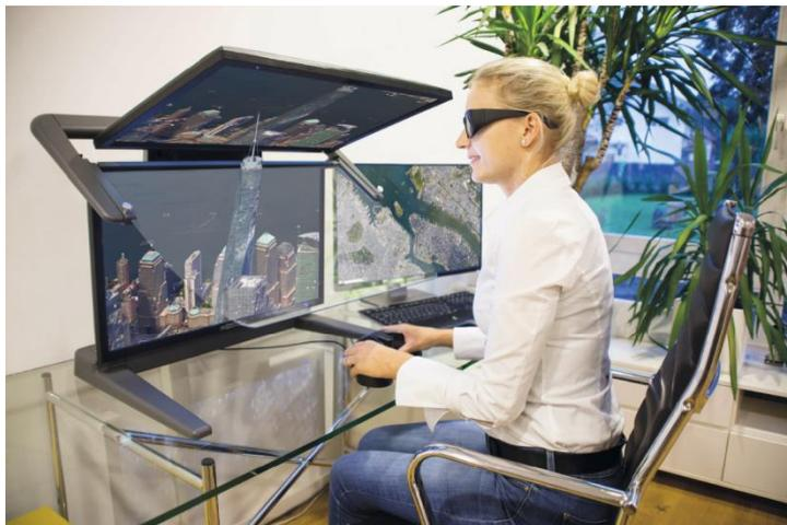
Der neue 3D PluraView basiert auf der Beamsplitter-Technologie und ermöglicht so hochauflösende 3D-Stereo-Visualisierungen mit einem flimmerfreien, tageslichttauglichen 3D-Display, das ein nahezu ermüdungsfreies stereoskopisches Arbeiten über Stunden garantiert.
