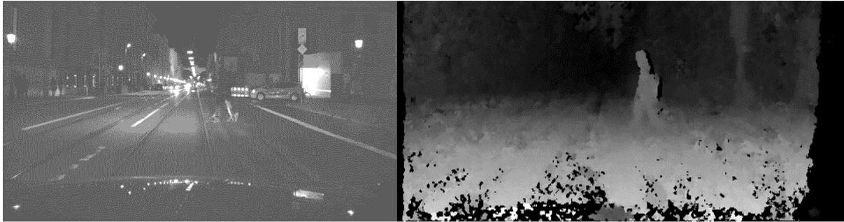
Abb. 3: Beispielaufnahme (aufgehellt) eines Fahrzeug-Stereokamerasystems in der Nacht. Links: Rektifiziertes Grauwertbild, rechts: Disparitätsbild.
