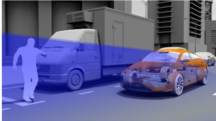
Abb. 1: Unfallvermeidung durch Detektion eines Fußgängers im Fahrweg des Autos mit Hilfe eines Stereokamerasystems am Innenspiegel [CONTINENTAL, 2011]
