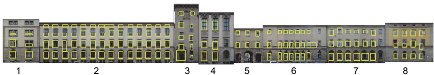
Abb. 6: Texturen und rekonstruierte Fenster für Fassadenteile 1 bis 8 (von links nach rechts)
