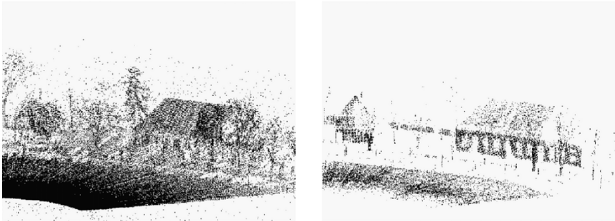
Abb. 15: Vorsegmentierung der Punktwolke einer Szene. a) mit teilweise durchdringbaren Objekten, b) von planaren Oberflächen
